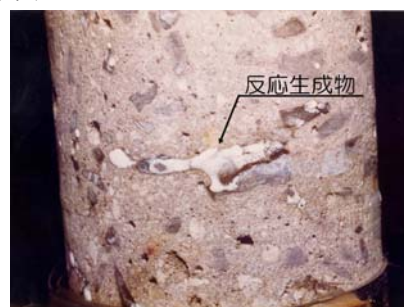
図 1.1-1 アルカリ骨材反応のメカニズム
