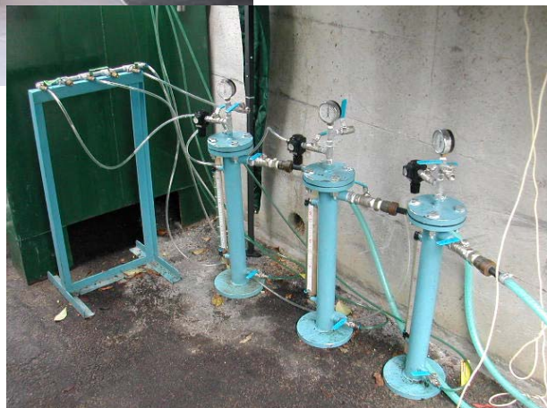
図 3.3-2 試験加圧注入用圧入装置
