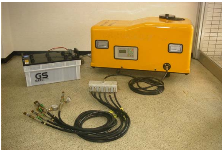
図 3.3-6 油圧式圧入装置
