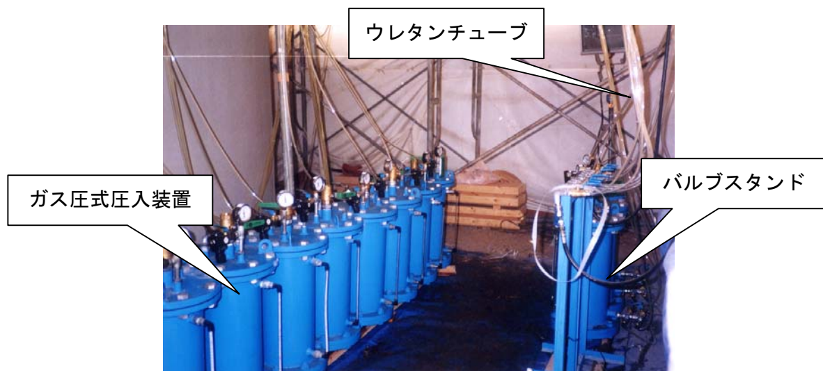
図 3.3-5 圧入装置とバルブスタンドの配置例
