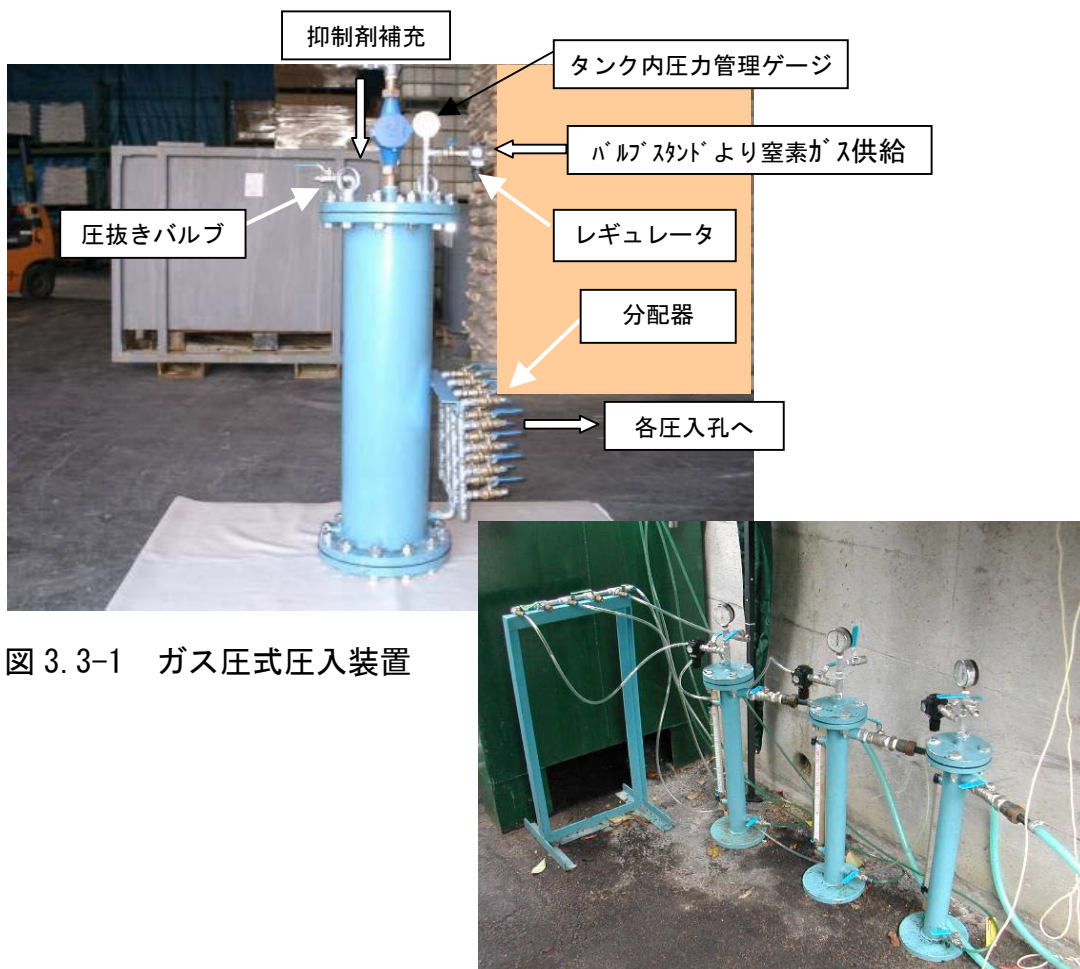
図 3.3-2 試験加圧注入用圧入装置
